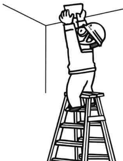
上向きの作業をした為、立ちくらみで バランスを失い転落
