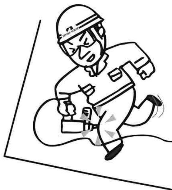
エアホースを外さずに移動して足に釘を打つ
