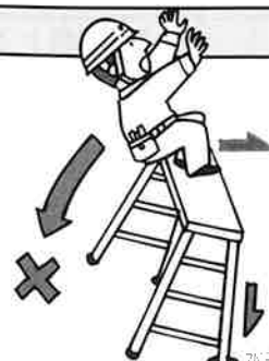
脚元の状態を確認して設置する
